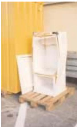
Bild 12: Folge der Verwendung eines **nicht** explosionsgeschützten Kühlschranks
